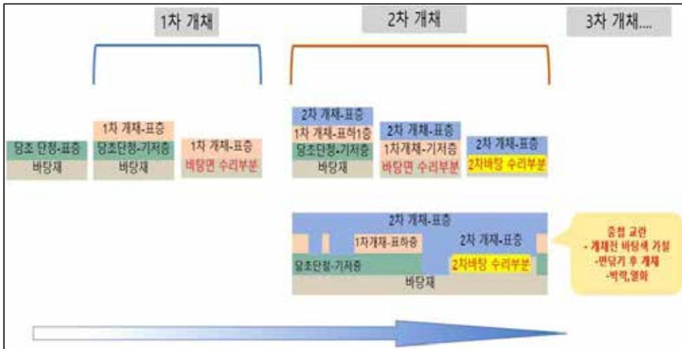
그림 18 중첩흔 조사를 통한 수리연혁분석 원리 모식도
